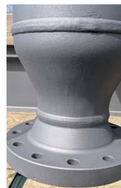
Photo d'arrière-plan : gros plan de la surface de cette bride de tuyau, sablée avec un abrasif 10X. Notez la qualité de finition sur la zone soudée.
