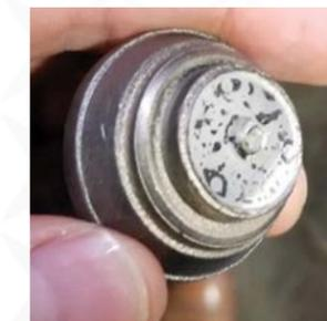
Rupture de liaison à 5 000 PSI avec préparation de surface en carbure de silicium.
