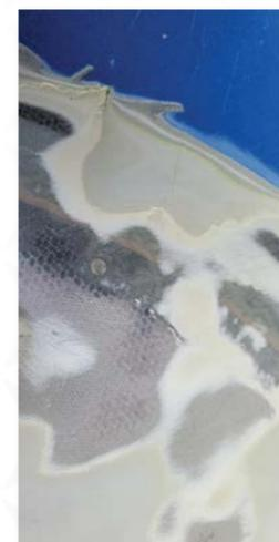
*EpiX MP* enlève le revêtement à base d'uréthane du capot du moteur d'avion composite Pilatus PC-12 sans causer de dommages
