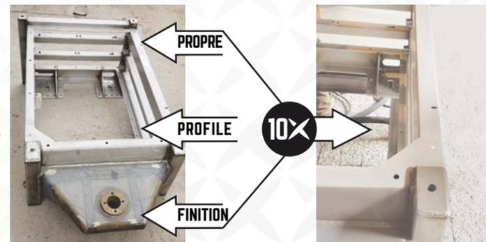
Châssis en acier inoxydable avant le sablage
