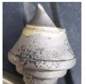
La liaison a résisté à 18 000 PSI avec la préparation de surface EpiX EP – le carbure de tungstène s'est cassé avant la liaison.
